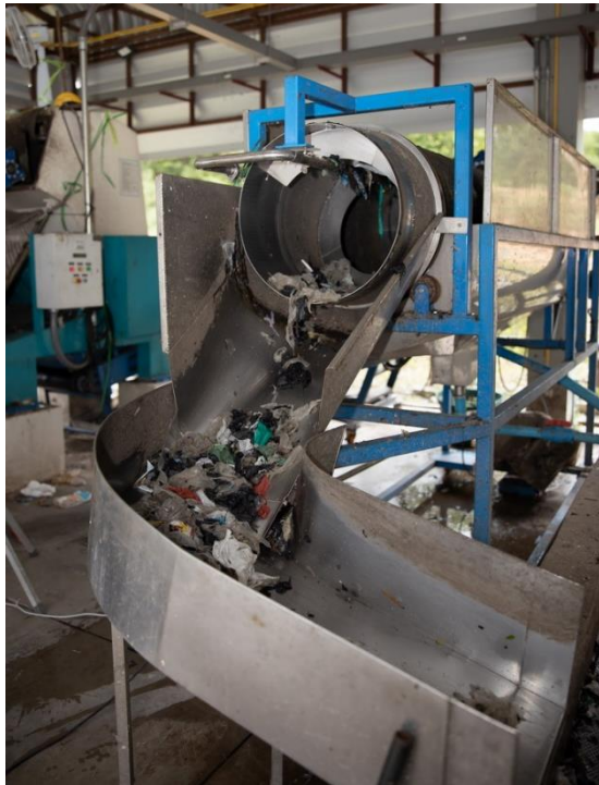
ระบบคัดแยกขยะ จะใช้ระบบคัดแยกขยะเชิงกลกายภาพที่มีประสิทธิภาพ โดยใช้คนงานน้อย ร่วมกับระบบคัดแยกขยะด้วยแรงงานคนบนสายพาน
